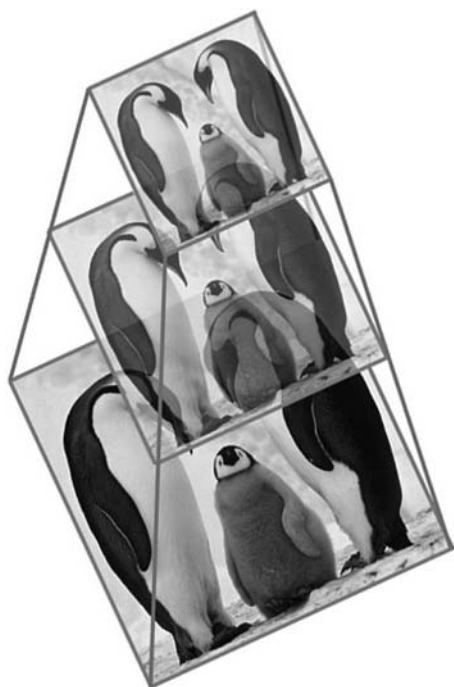
Рис. 1. Пирамида Гаусса для иерархического подхода к вычислению оптического потока
