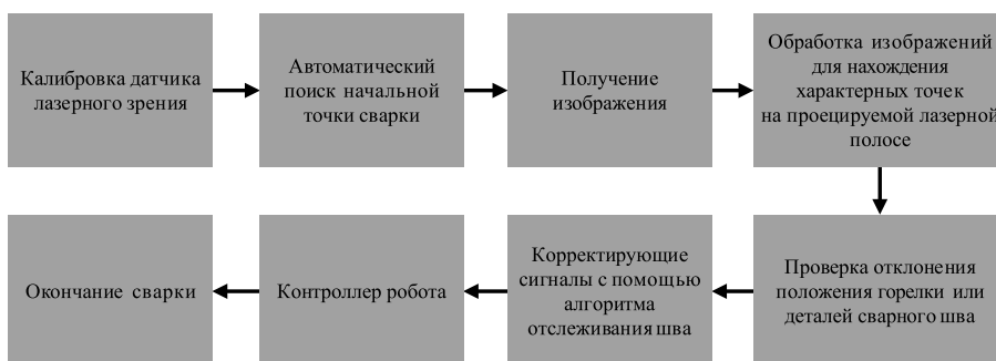
Рис. 2. Отслеживание стыка с использованием датчика лазерного зрения
