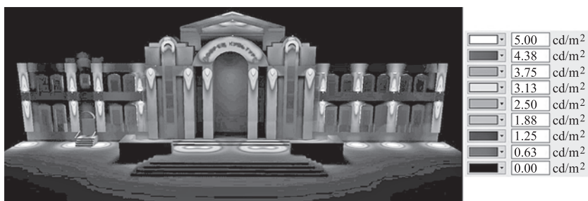
Рис. 5. Уровни распределения яркости на поверхностях фасада здания
