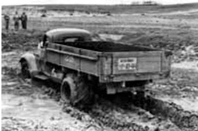
Рис. 3. Движение автомобиля ЗИС-150 по участку с глубоким слоем ила [3]
