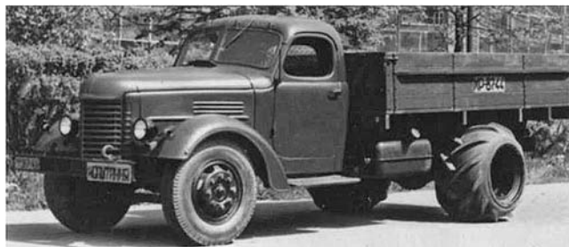
Рис. 1. Автомобиль ЗИС-150, оборудованный колёсами с ародными шинами [6]
