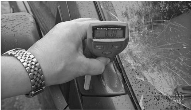
Рис. 5. Результат измерения толщины ЛКП стойки
