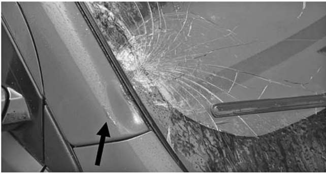
Рис. 4. Стойка кузова передняя правая и правая боковая часть ветрового стекла
