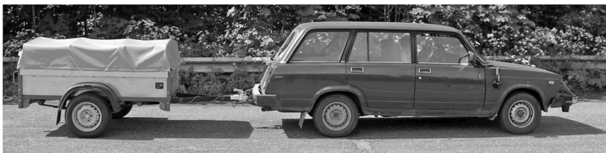
Рис. 1. Легковой автопоезд ВАЗ-21043 + САЗ-82994 при выполнении типового манёвра "смена ряда"
