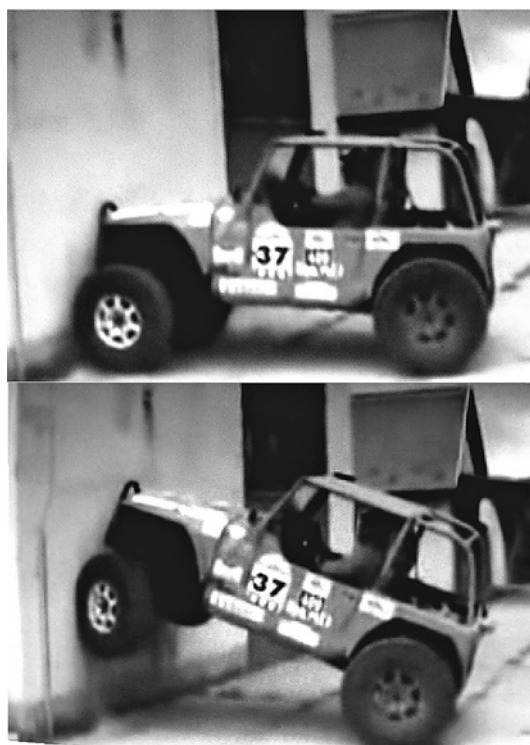
Рис. 2. Этапы въезда полноприводного автомобиля передними колёсами на вертикальную стену ( h_3^{\max} > r_k )
