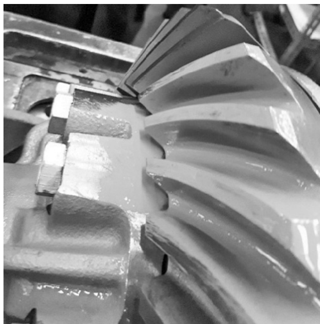
Рис. 17. Опытно-экспериментальная технологическая оснастка для регулировки преднатяга подшипников дифференциала редуктора
