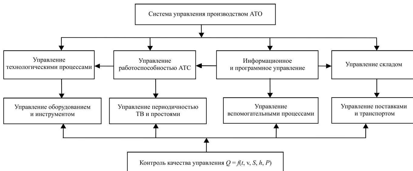
Рис. 2. Структура системы управления производственными и вспомогательными процессами АТО
