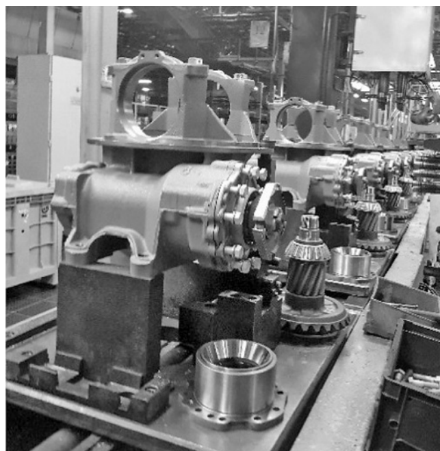
Рис. 14. Автоматизированный конвейер для сборки редукторов с подпольным возвратом спутников для сборки
