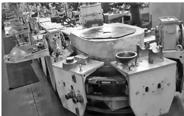
Рис. 15. Конвейер для сборки редукторов кольцевой замкнутой системой перемещения собираемого узла с позиции на позицию
