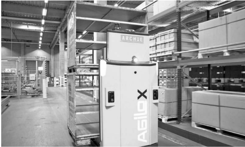
Рис. 4. Беспилотный вилочный погрузчик фирмы AgiloX
