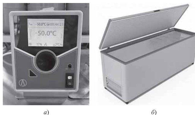
Рис. 2. Криостат LOIPFT-311-80 (а) и морозильная камера PozisFH-258-1 (б) для выдержки образцов при отрицательных температурах
