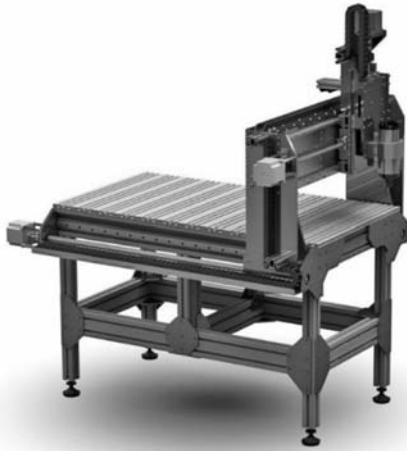
Рис. 2. Трехкоординатный фрезерный станок с ЧПУ портального типа
