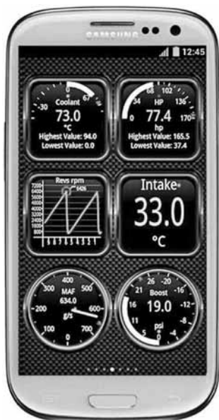
Рис. 4. Мобильное устройство (смартфон) с установленным приложением для бортовой диагностики автомобилей
