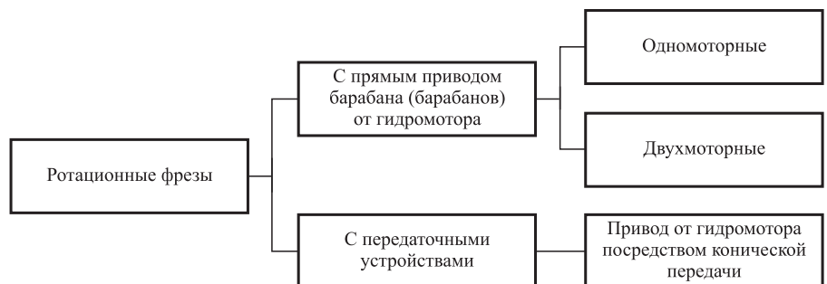
Рис. 1. Классификация ротационных гидравлических фрез
