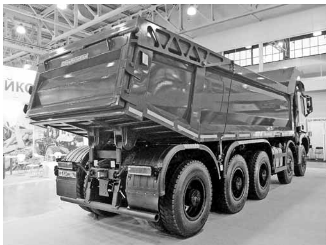
Объем кузова СпецАвтоКам в скальном исполнении составляет 26 м 3
