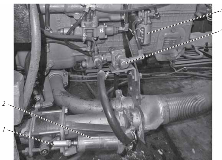
Рис. 2. Вид установленного на стенде двигателя КАМАЗ-740 с моторным тормозом в выпускном тракте:
