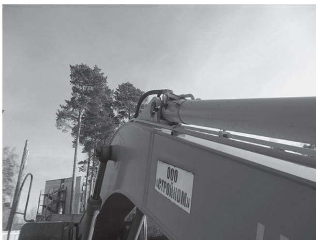
Рис. 7. Излучатель устройства на корпусе (гильзе) исследуемого гидроцилиндра привода рукояти экскаваторов Liebherr R317 Litronic (а) и Hitachi Zaxis 230 с ковшем 1,4 м 3 (б)
