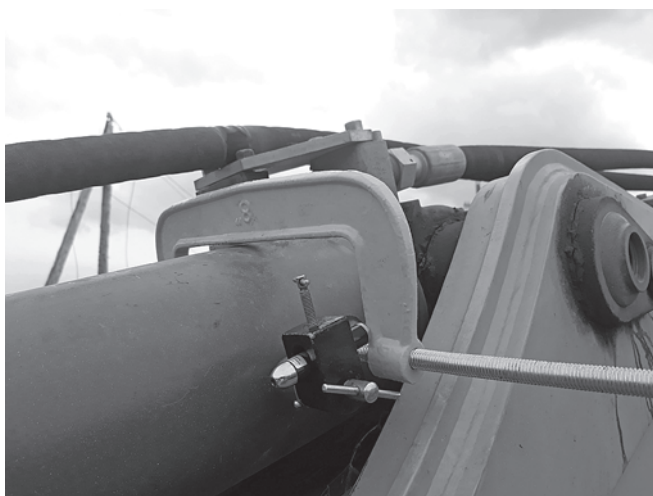
Рис. 6. Приемник и минивидеокамера на штоке исследуемого гидроцилиндра
