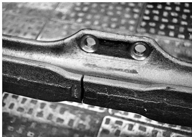
Рис. 2. Место разрушения балки переднего моста при усталостных испытаниях
