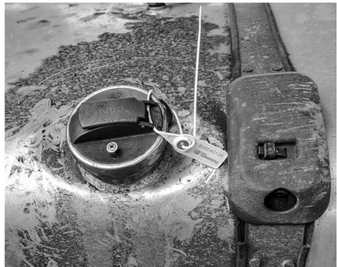
Рис. 4. Фотографии запломбированного ДУТ
