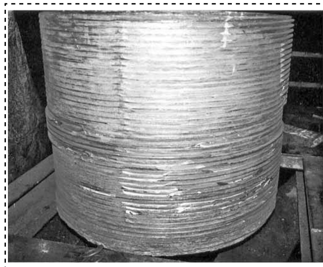
Рис. 2. Частично корродированная внешняя резьба колонны
