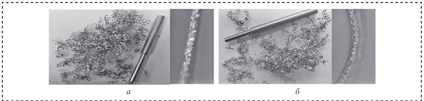
Рис. 4. Типичная стружка от прутка диаметром 8 мм до (а) и после (б) ГИП
