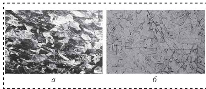
Рис. 3. Структура материала прутка до (а) и после (б) отжига, \times 100
