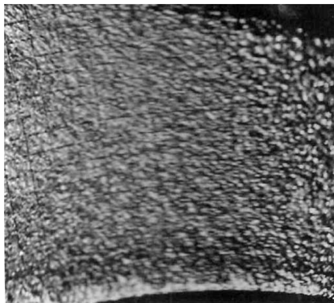
Рис. 4. Деформация координатной сетки неравностенного образца из АРМКО-железа при дорновании отверстия с натягом 2,4 мм
