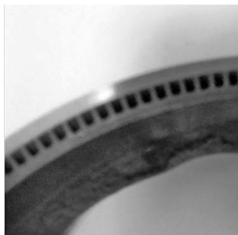
Рис. 4. Сечение камеры сгорания с каналами для охлаждения топливом
