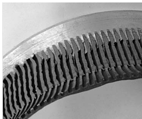
Рис. 3. Фрагмент камеры сгорания с пазами для прокачки охлаждающей жидкости
