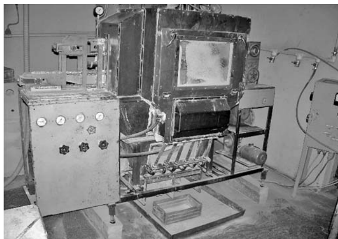
Рис. 3. Опытная установка пескоструйной резки
