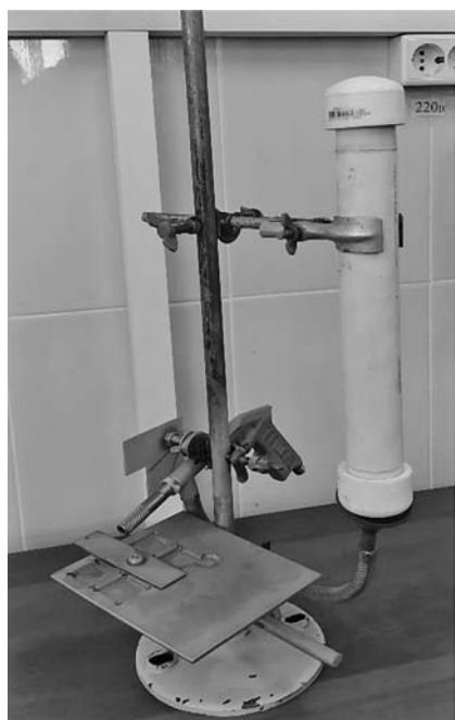
Рис. 2. Лабораторная установка эрозионного износа ЭИ-01
