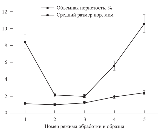
Рис. 8. Объемная пористость и средний размер пор покрытий, полученных при различных режимах обработки
