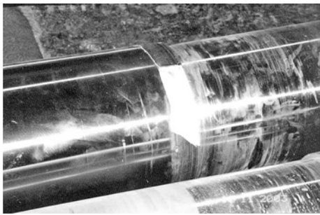
Рис. 1. Откол (белый цвет) слоя плазменной закалки на валке
