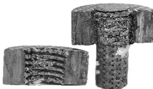
Рис. 5. Характер разрушения резьбовой пары из УУКМ при высоких температурах
