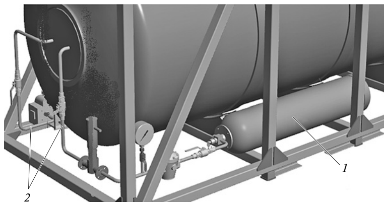
Рис. 5. Система наддува корпуса инертным газом
