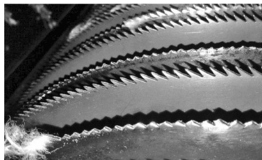
Рис. 6. Эксплуатационное состояние пильных дисков после 168 ч работы, установленных чередованием (с упрочнёнными и неупрочнёнными зубьями) на одном джине 5ДП-130
