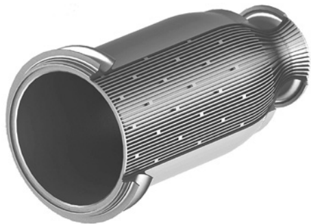
Рис. 2. Камера сгорания с дополнительными полыми перемычками между ребрами тракта охлаждения
