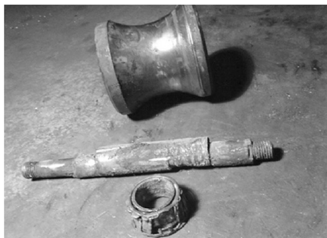
Рис. 1. Износ и разрушение деталей арматуры FRS9
