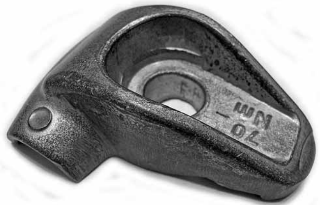
Рис. 6. Силуминовая отливка "плашка" (масса ~0,21 кг, толщина стенки 5...14 мм, максимальный габаритный размер 105 мм)
