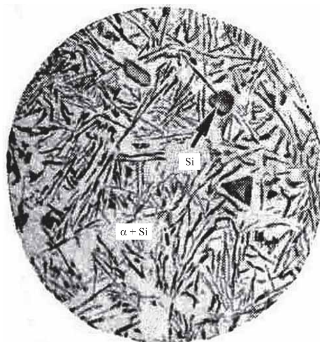
Рис. 1. Микроструктура заэвтектического силумина (13 % Si) [1, 3, 4]
