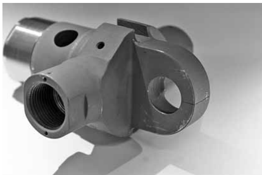
Рис. 1. Исследуемая деталь с трещиной в зоне проушины после виброиспытаний
