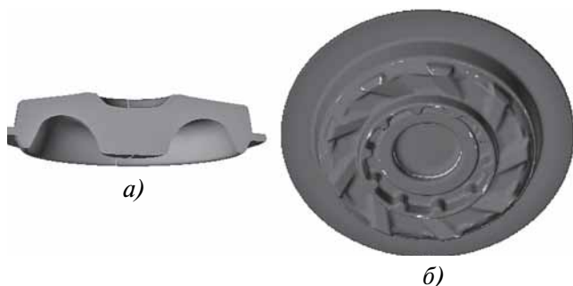
Рис. 11. Результаты моделирования процесса штамповки поковки крышки с гравюрой предварительного ручья, спроектированной по тепловой модели:
