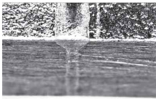
Рис. 2. Макроструктуры сварочных швов, выполненных волоконным лазером:
