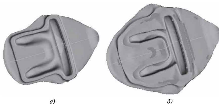
Рис. 16. Результаты моделирования модернизированного технологического процесса штамповки вилки:
