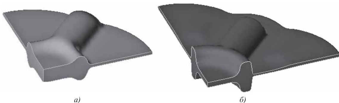
Рис. 4. Результаты моделирования технологического процесса штамповки крестовины с гравюрой предварительного штампа, построенного по изотерме теплового поля:
