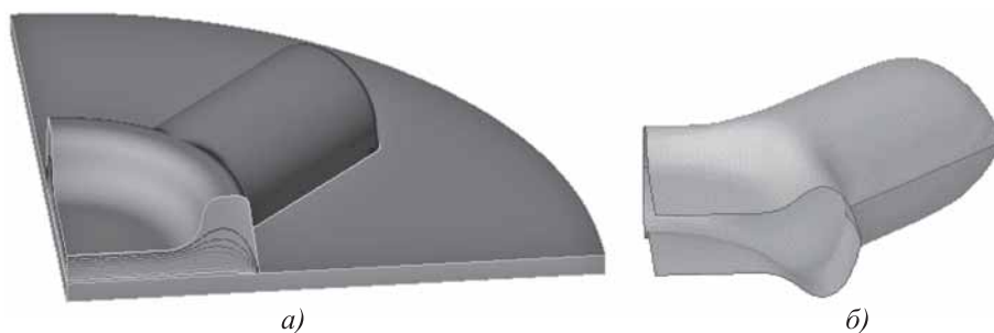
Рис. 3. Результаты моделирования теплового поля для проектирования предварительного ручья поковки крестовины:
