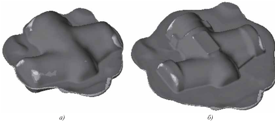
Рис. 12. Результаты моделирования модернизированного технологического процесса штамповки корпуса:
