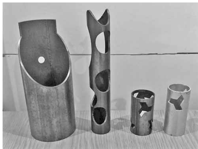
Рис. 3. Трубы с отверстиями, вырезанными волоконными лазерами
