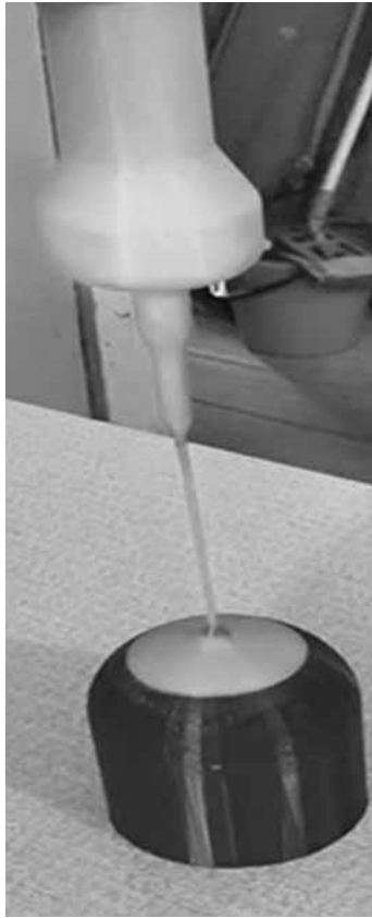
Рис. 5. Выжигаемая модель пробы на заполняемость из пластика PLA
