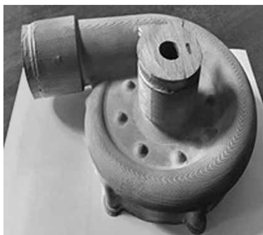
Рис. 3 Отливка "улитка турбокомпрессора", полученная гравитационным литьем по выжигаемой модели из пластика PLA в керамические формы
