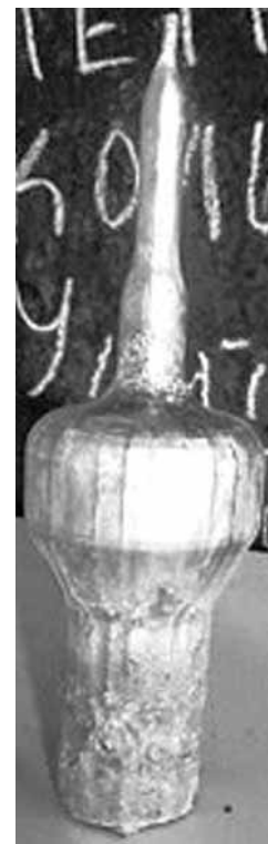
Рис. 7. Проба на заполняемость, полученная гравитационной заливкой
