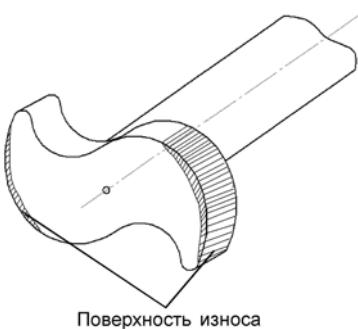
Рис. 1. Изношенные поверхности разжимного кулака
