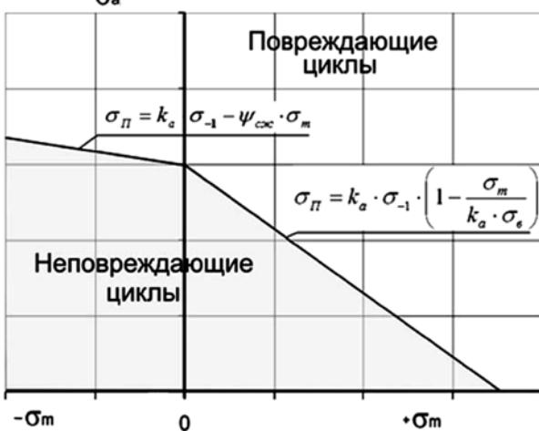
Рис. 1. Определение повреждающих циклов случайного процесса
