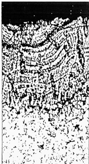
Рис. 1. Микроструктура железного покрытия на стали 30Х, полученного из хлористого электролита на асимметричном токе ( $\times 500$ )
