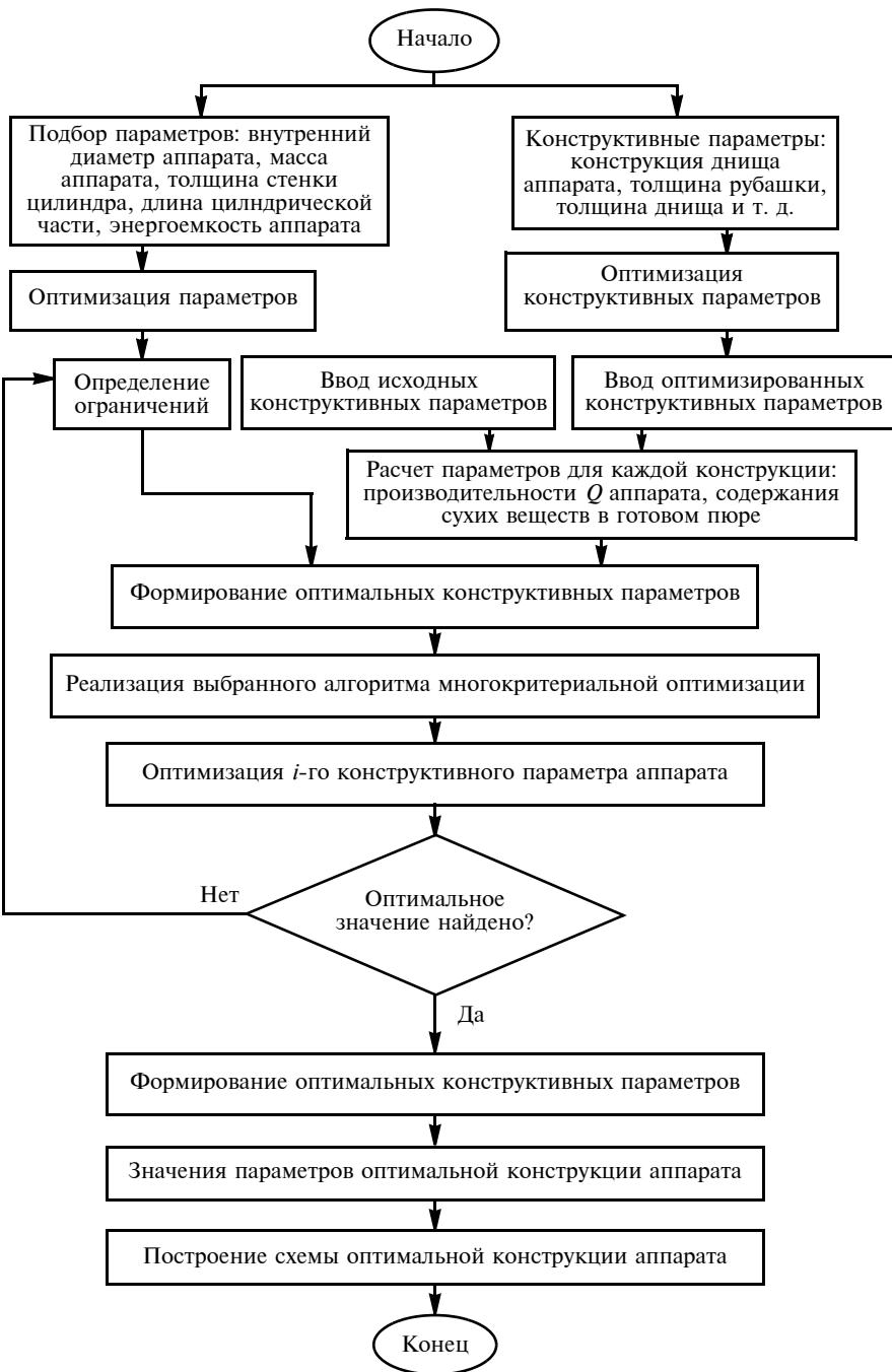
Рис. 3. Алгоритм работы блока оптимизации подсистемы САИР ВВА
