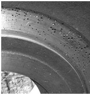
Рис. 8. Отливка "кольцо", пораженная светлыми газовыми раковинами по всему объему
