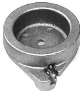
Рис. 9. Отливка "крышка" с крупной светлой блестящей газовой раковиной
