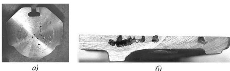
Рис. 3. Отливка "груз" с раковиной гладкой светлой блестящей (а) и увеличенное изображение дефекта (б)
