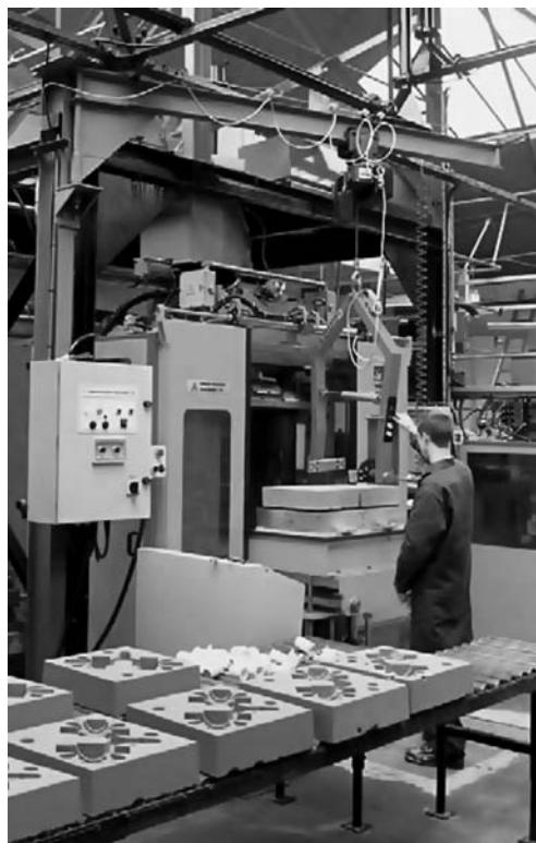
Рис. 1. Изготовление форм по фенол-уретановому процессу
