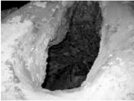
Рис. 1. Разрез зашлакованного КБТ
