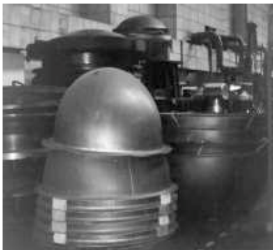
Рис. 2. Полусферические тонкостенные днища из листов титанового сплава ПТ-3Вкт
