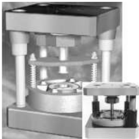
Рис. 1. Твердотельная модель штампа с динамической центрацией инструмента и опытный образец
