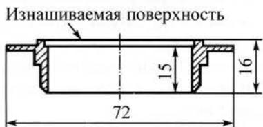
Рис. 1. Втулка торцового уплотнения гидропривода ГСТ-90
