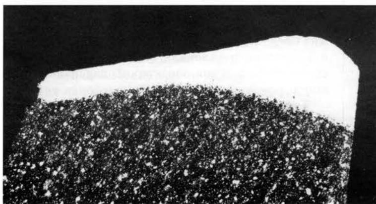
Рис. 1. Поперечный шлиф ( $\times 100$ ) зуба развертки Р9К5 после лазерной обработки
