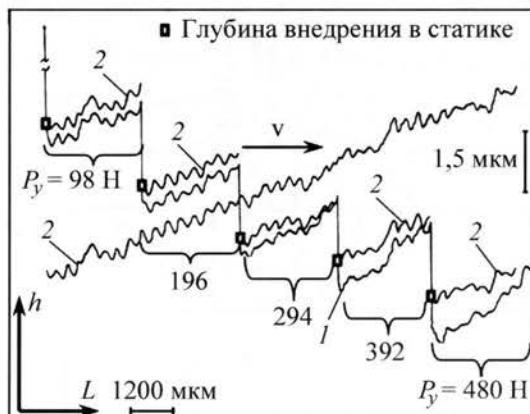
Рис. 2. Изменение суммарной глубины внедрения  $h_{\Sigma_d}$  сферического индентора из синтетического алмаза с радиусом  $R_{\text{сф}} = 3 \text{ мм}$  при его тангенциальном смещении по стальной пластине (100 HV) в координатах  $h-L$ :
