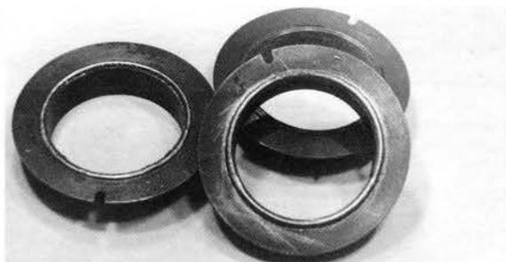
Рис. 2. Рабочая поверхность уплотнительного пояска втулок, восстановленных дуговой порошковой наплавкой в вакууме
