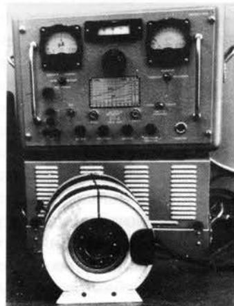
Рис. 1. Установка для обработки полимерных изделий в магнитном поле
