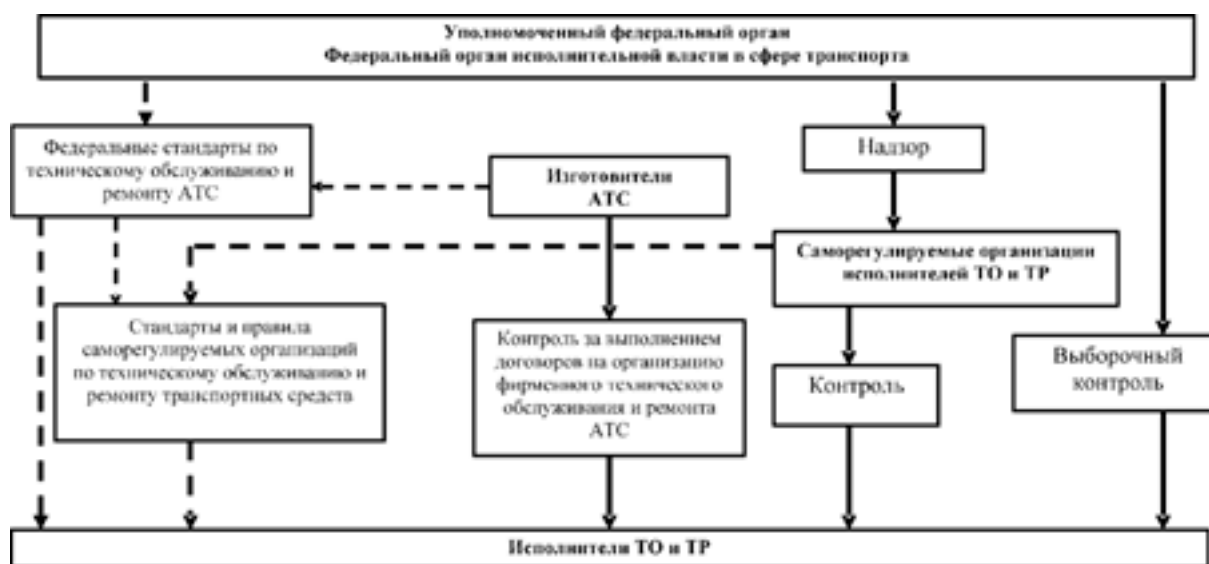
Рис. 2. Регулирование деятельности по техническому обслуживанию и ремонту транспортных средств: → — административные связи; ----> — информационные связи
