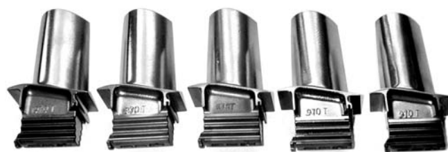
Рис. 5. Лопатки ТВД РД33 из сплава ЖС26НК с покрытием СДП-2 после облучения СИЭП, приготовленные для длительных натурных испытаний на двигателе
