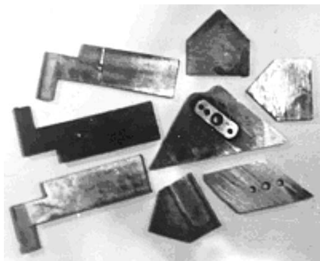
Рис. 8. Детали крупновязальной машины "Бетлей-22" после ЭКХТО
