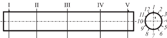
Рис. 2. Схема измерений образцов в поперечных сечениях
