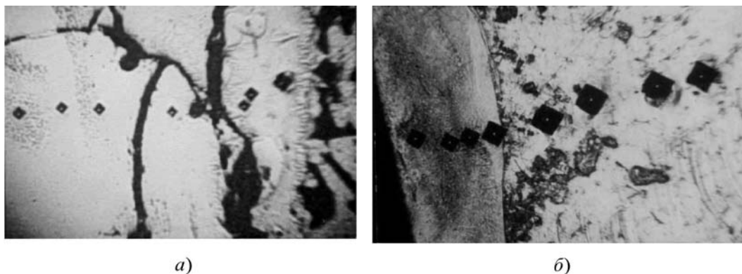
Рис. 2. Микроструктура слоев со следами измерения микротвердости при импульсно-дуговом упрочнении стали 10 через порошок V_4C (а) и порошок интерметаллида Ni_3Ti (б) титановым электродом ( \times 100 )
