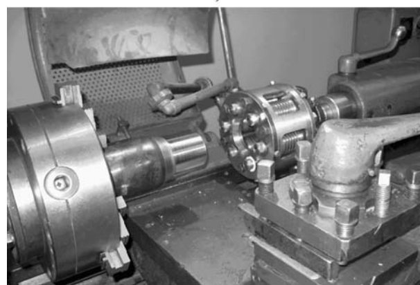
Рис. 3. Резьбонакатная головка ГРК 1: а – трехмерная модель; б – фотография
