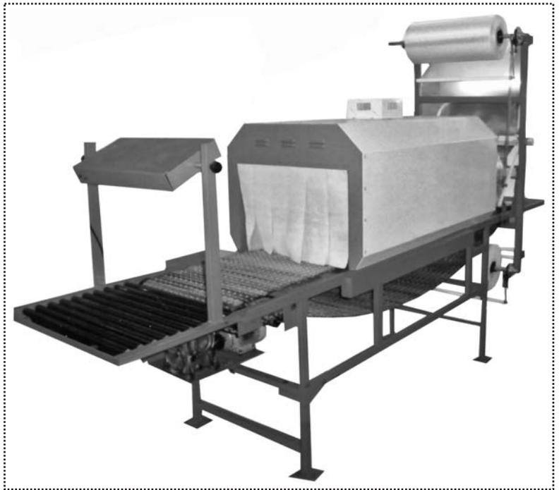
Рис. 4. Термотоннель УТ-1000
