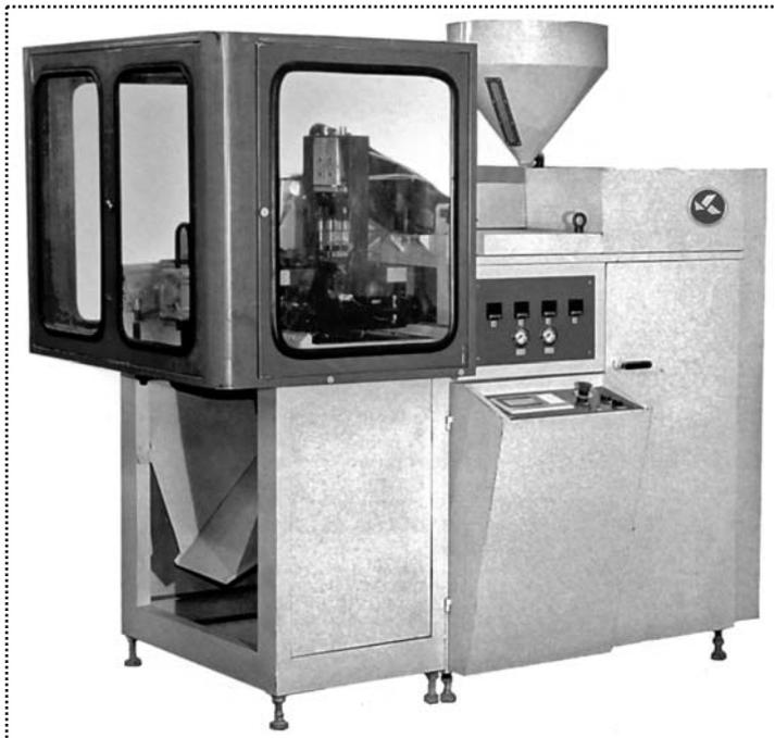
Рис. 2. Автоматическая экструзионно-выдувная установка ВП-24-А
