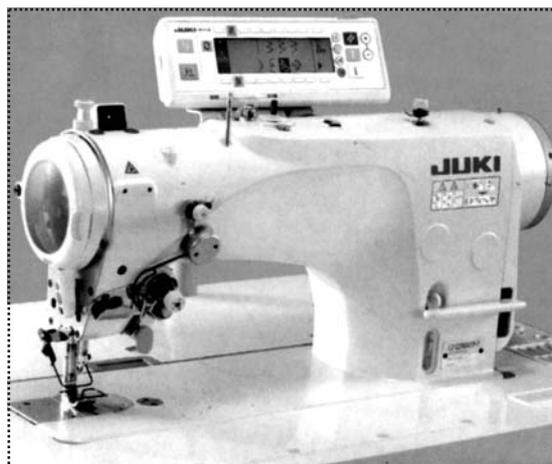
Рис. 3. Высокоскоростная одноигольная машина мод. LZ-2290A-SR-7
