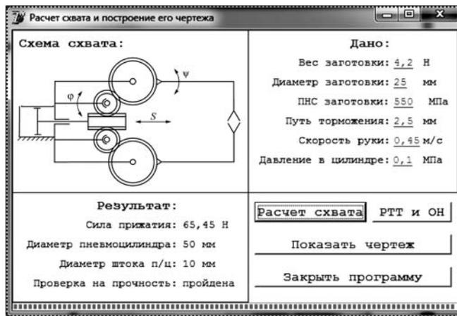
Рис. 4. Окно вывода основных параметров схвата
