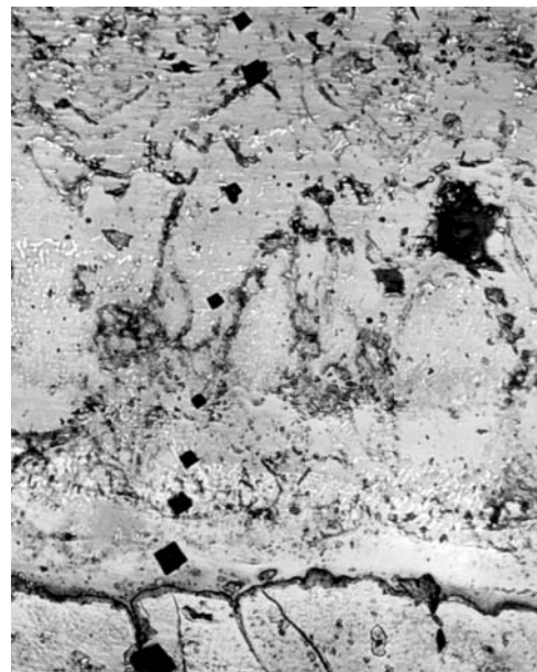
Рис. 4. Микроструктура двухслойного покрытия NiCr + Al толщиной 0,2+0,2 мм и граница контакта со сталью после выдержки 7 ч при 1000 °С (×300)
