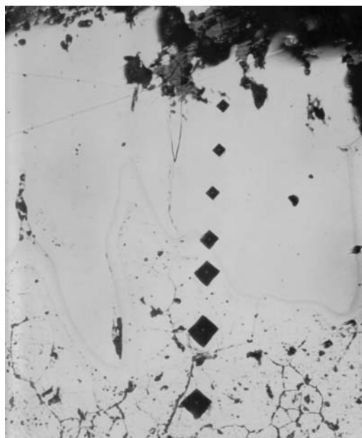
Рис. 2. Микроструктура покрытия из Al после 2 ч выдержки при 800 °С (×300)
