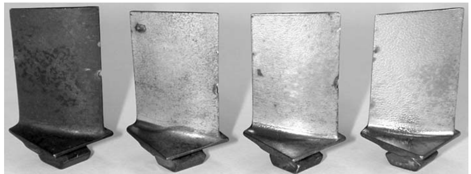
Рис. 1. Внешний вид лопаток из стали ЭП866Ш после 260 ч эксплуатации на двигателе РД33 и облучения двумя импульсами на ускорителе GESA-1: слева направо – исходная лопатка после наработки, W = 20...22 ; 26...28 и 32...36 Дж/см 2
