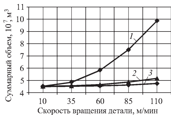
Рис. 7. Зависимость суммарного объема от ультразвуковой частоты при A = 20 мкм, F_{ст} = 50 Н, s = 0,08 мм/об, D = 4 мм: 1 – 18 кГц; 2 – 44 кГц; 3 – 66 кГц
