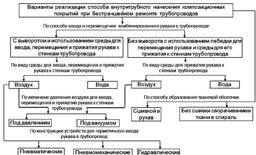
Рис. 1. Классификация вариантов реализации способа внутритрубного нанесения композиционных покрытий при бестраншейном ремонте трубопроводов
