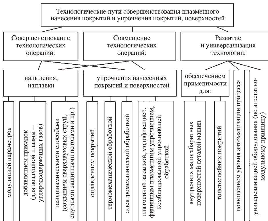
Рис. 1. Технологические пути совершенствования плазменного нанесения покрытий и упрочнения покрытий, поверхностей
