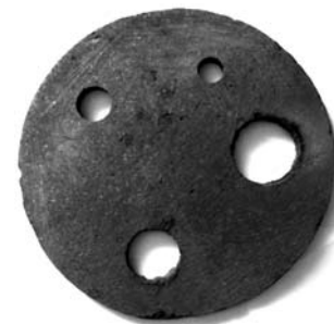
Рис. 2. Графитовая форма для наплавки точечных покрытий различного диаметра по слою металлического порошка
