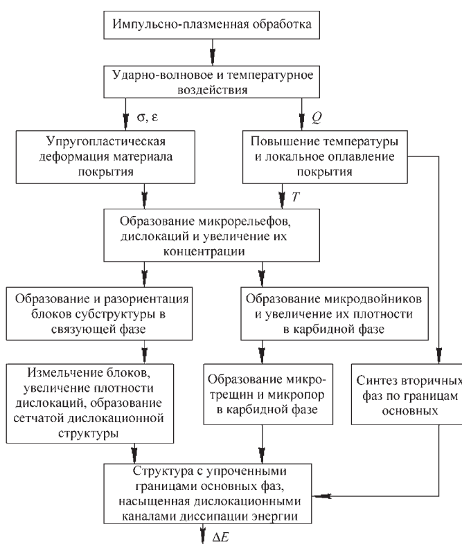
Рис. 2. Физическая модель формирования дислокационной структуры напыленных композиционных покрытий, обработанных импульсами плазменной струи
