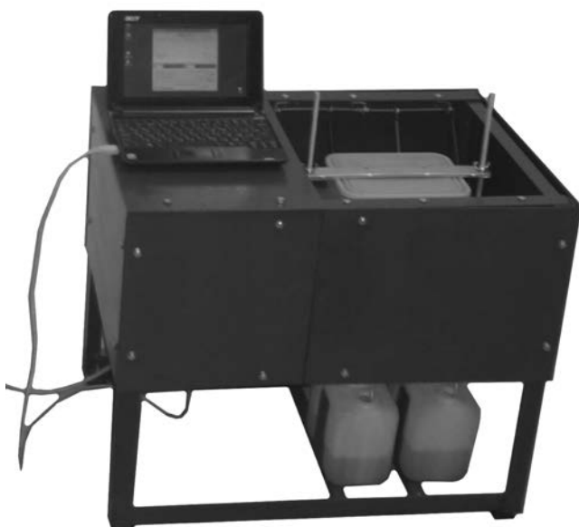
Рис. 1. Новый комплекс для осуществления вибрационной обработки с автоматизированным циклом обработки
