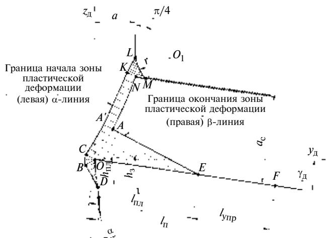
Рис. 2. Схема полей линий скольжения при  $\gamma_d \neq 0$  и  $\alpha \neq 0$
