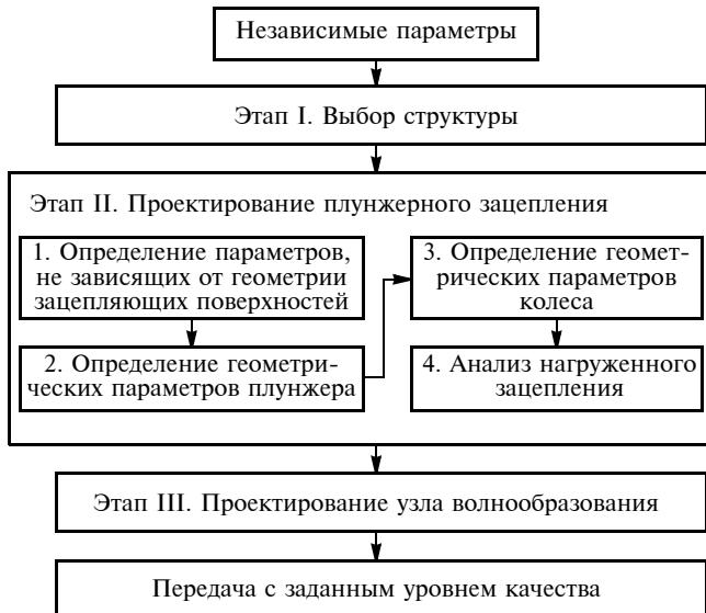
Рис. 4. Схема проектирования плунжерной передачи
