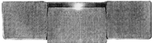
Рис. 17. Зарождение разделяющих трещин при пробивке в штампе заготовки из стали 45 (опытный образец А. Л. Воронцова)
