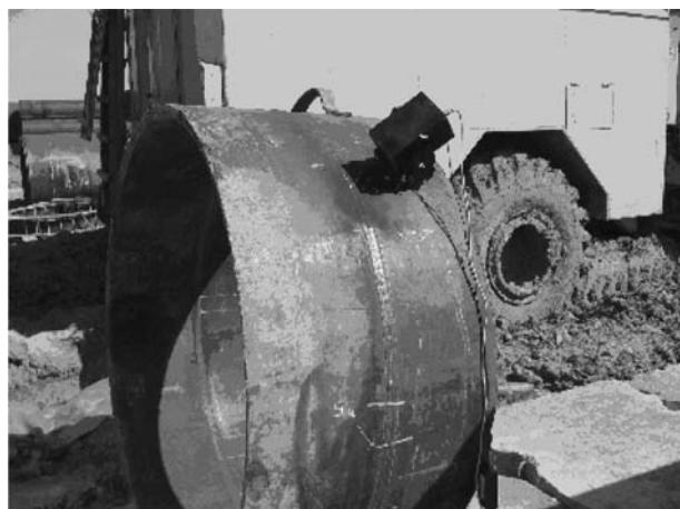
Рис. 9. Оптический блок комплекса на исследуемом контрольном стыковом соединении
