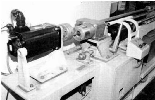
Рис. 3. Серводвигатель
