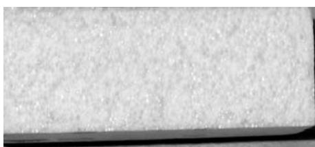
Рис. 6. Излом модели, представленной на рис. 5. Края четкие, структура спеченная, рыхлот нет
