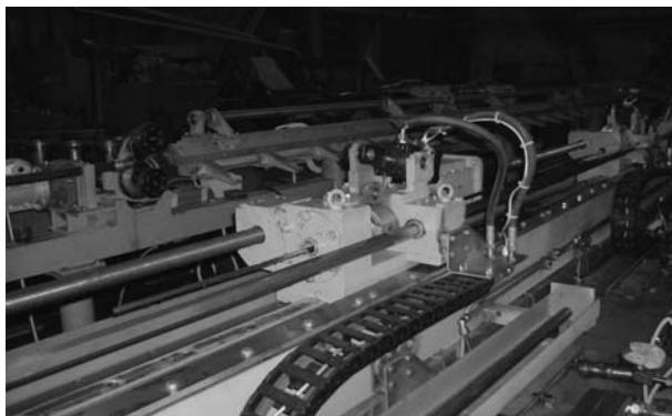
Рис. 6. Патрон подачи заготовки стана ХПТ 6-20
