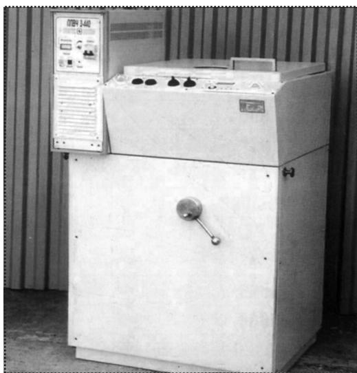
Рис. 3. Центробежная индукционная плавильная установка мод. УИПЦ-3-440-0,5
