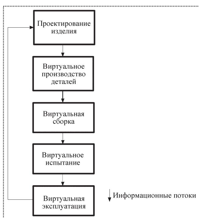
Рис. 3. Использование технологии виртуальной сборки на стадии создания нового изделия и доводки технологии его изготовления
