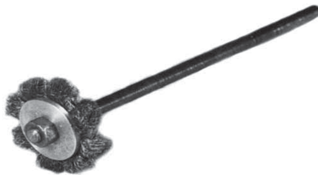
Рис. 3. Дисковый секционный электрод-щеточка для обработки внутренних поверхностей
