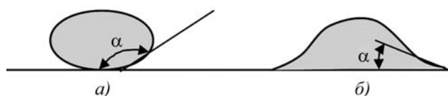
Рис. 2. Угол смачивания поверхности: а – смачиваемой; б – гидрофобной
