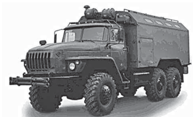
Рис. 1. Мастерская зарядки и ремонта аккумуляторов МЗА-М2.1 на шасси "Урал-4320-31"
