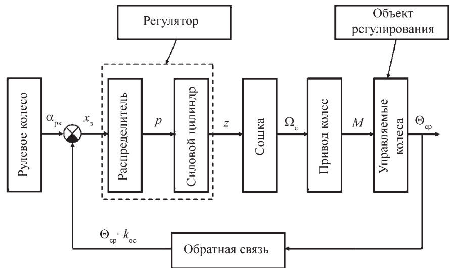
Рис. 2. Функциональная схема системы рулевого управления с интегральным рулевым механизмом и роторным распределителем
