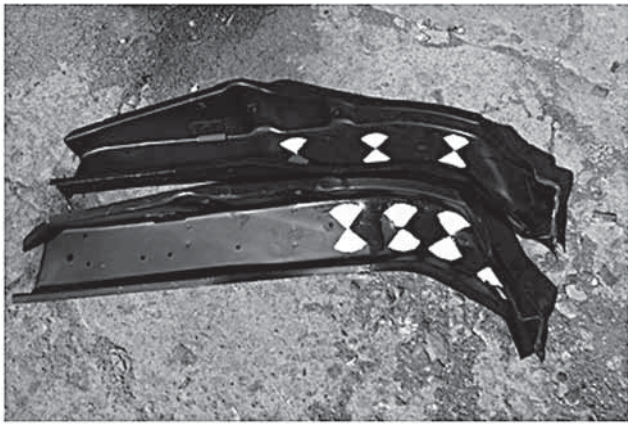
Рис. 2. Лонжероны после проведения испытаний
